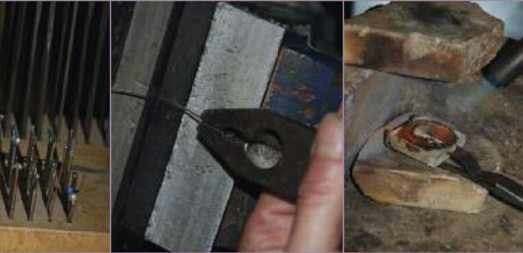
Drabt ziehen mit Zieheisen und Zange, Silber schmelzen an der Esse
