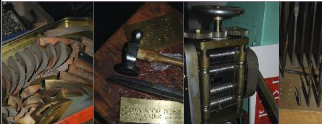
Material und Werkzeuge v.l.: Rohlinge in Sand gegossen, Ziselierhammer und Schriftmeißel, Blech- und Drahtwalze, Feilen und Fräser,
