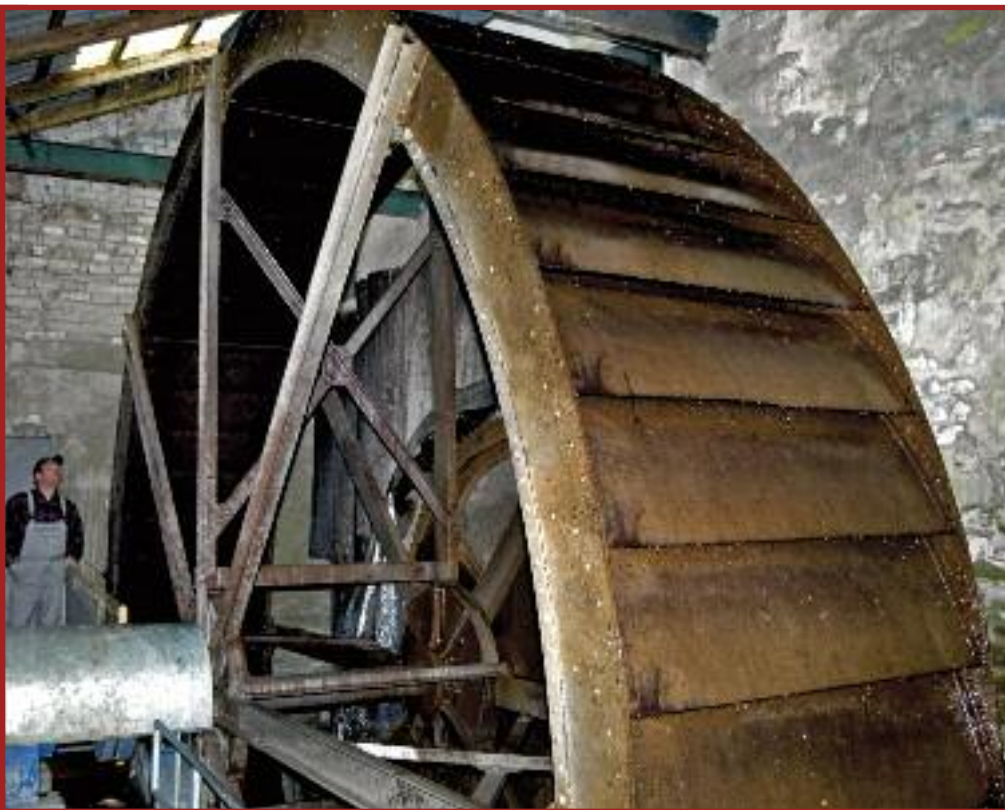
Das fast sieben Meter hohe ober-schläch-tige Wasserrad hat eine Energieeffizienz von über 90 Prozent.
